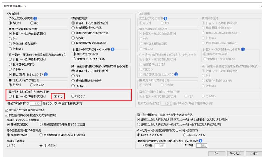
計算ルート3でも設計者判断で意図的にフロー③④の検討を行いたいという場合以外は、デフォルトの‘計算ルートにより自動設定’としてください。
