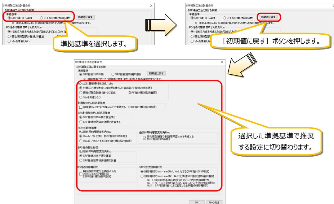
選択した準拠基準は、計算書の「SRF 補強工法に関する指定」で確認することができます。
