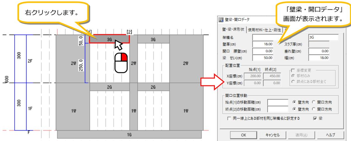
4. 開口幅を狭くしたい場合は、[開口方向]を選択して、[移動距離]を入力します。始点[1]の移動距離は50cm、終点[2]の移動距離は100cmです。
