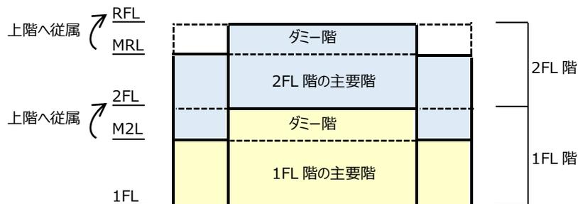
A. 応力解析という観点では、ダミー階も含めて建物全体で応力解析しますので、ダミー階も計算に使います。
