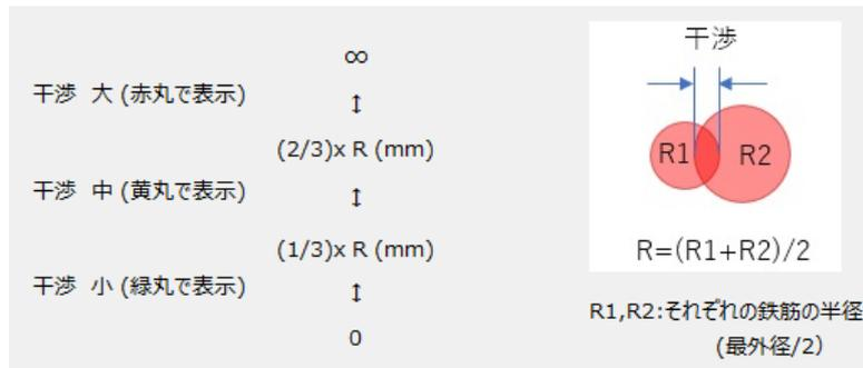
判定方法を「干渉度合を実寸で判断」とする場合は、判定値（干渉寸法）を使用者が設定することができます。「干渉度合を実寸で判断」に変更する場合は、リボンメニューの[ツール]タブから[割合で判定]を選択します。「干渉度合判定値設定」画面が表示されるので[干渉度合を実寸で判断]タブを選択し、必要に応じて判定値を変更した上で[OK]ボタンを押してください。変更が完了するとリボンメニューの[割合で判定]（以下の図の②）が[実寸で判定]に変わります。
