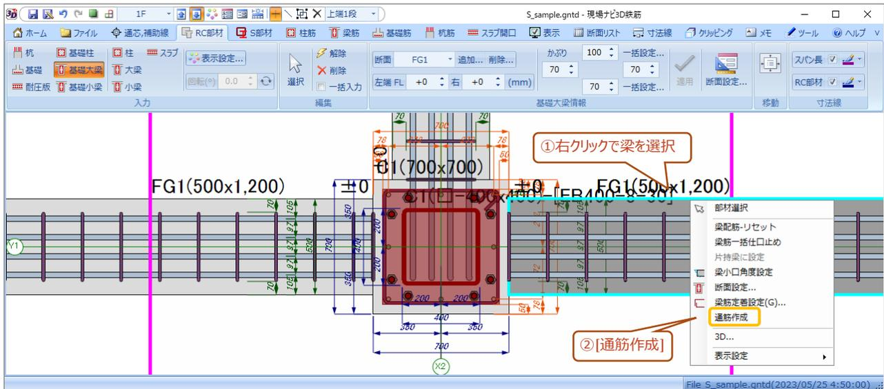
特定の主筋をつなげて通し筋にしたい場合、[通筋作成]を選択しても意図した配筋にならないことがあります。その場合は、[梁筋一括仕口止め]を選択した後、リボンメニューの[梁筋]タブから[つなぎ込み]を選びます。伏図で対象の鉄筋をクリック&ドラッグでつないで、その後に[通筋作成]を選択してください。
