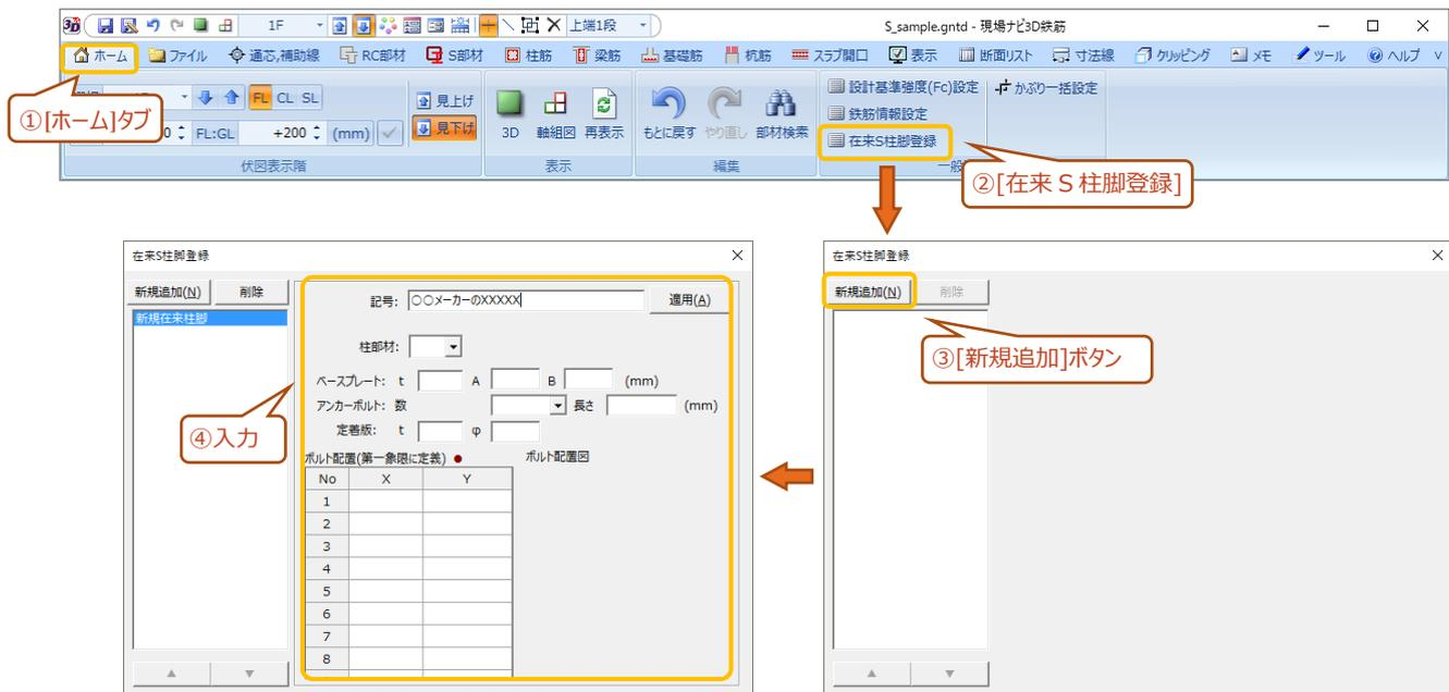
以後、配置時に用いる「S 柱脚」画面の製品名に[在来工法]が追加され、[在来工法]を選択すると、型式に上記画面で入力した記号が表示されるようになります。
