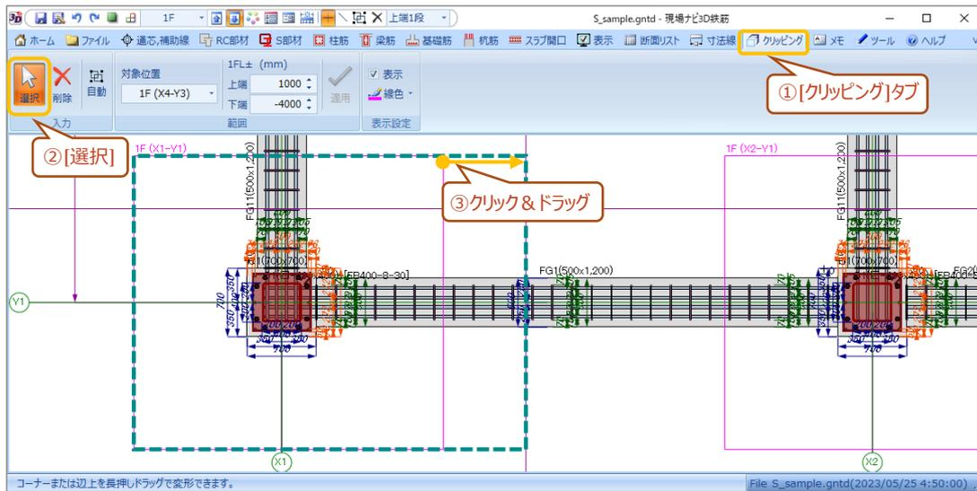
また、ピンクの枠内で右クリックし、ポップアップメニューから[クリッピング範囲回転]を選択すると回転することもできます。部材が傾斜している場合等に有用です。
